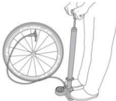
9. リムまたはタイヤに許容されている最大圧力でタイヤに空気を入れ、タイヤが適切にリムにフィットしていることを確認します。
