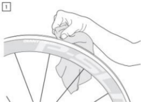
1. リムを清掃し、脱脂してください。50%イソプロピルアルコールを推奨します。
