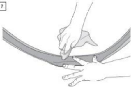
7. 水拭きして、タイヤの内側をきれいにしてください。シーラントを使う場合は、適量をタイヤ内部に注入します。
